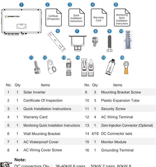
DC connectors Qty.: 36-40kW 6 pairs, 50kW 7 pairs, 60kW 8 pairs.
